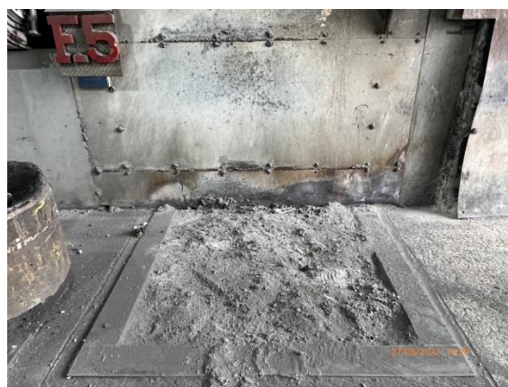
ภาพที่ 54 บ่อสำรองฉุกเฉินใต้เตาหลอม
