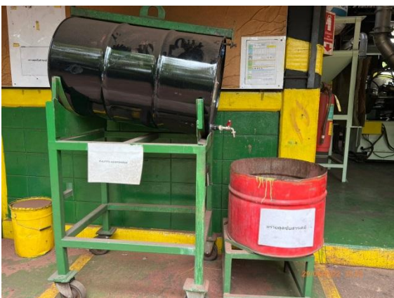
ภาพที่ 35 ทรายดูดซับสารเคมีหกั่วไหล
